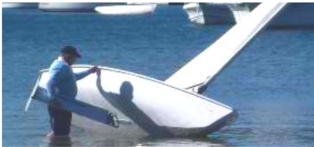
Im flachen Wasser wird ganz einfach das Schwert mit Tragfläche (Foil) von unten in den Kasten geschoben und schon geht's los. Auch das **Aufrichten nach einer Kenterung** ist einfach. Man soll allerdings auf das Schwert ganz beim Boot und nicht am Foilende steigen. Fotos: Segelreporter
